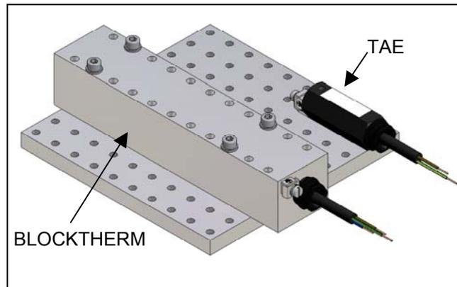
Нагревательный блок передаёт тепло за счёт теплопроводности. Поэтому он должен быть установлен на плоской поверхности теплопроводящего материала (например металла). Для крепления нагревательного блока необходимы два болта.
