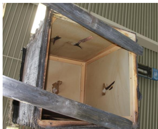
FireShelter внутренний вид после >60мин. при 1200°C/2000°F
