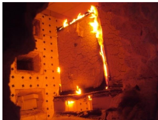
Fire Shelter в огневой камере при 1200°C/2000°F
