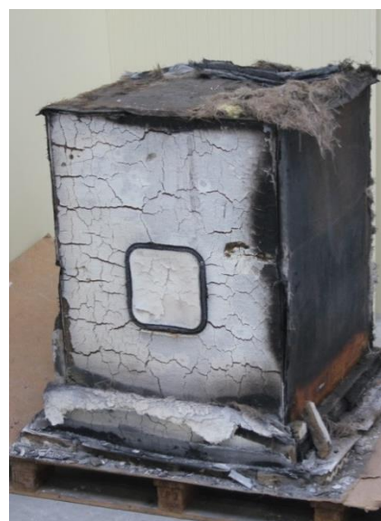
FireShelter после испытания >60 мин. при 1200°C/2000°F
