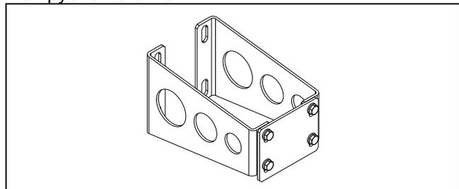
**Монтажная система MSW** для крепления вентиляльных блоков или датчиков
