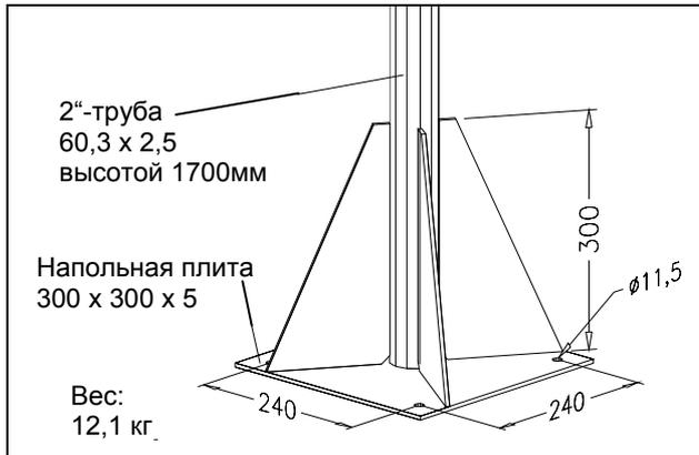
**ST17-2, высотой 1700мм** для крепления защитных козырьков
